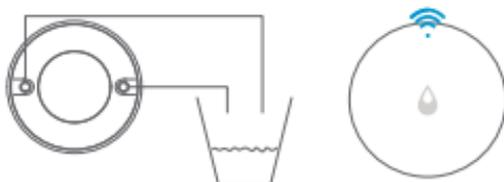
\* Die Antenne befindet sich gleich über dem Wassertropfen-Symbol.
