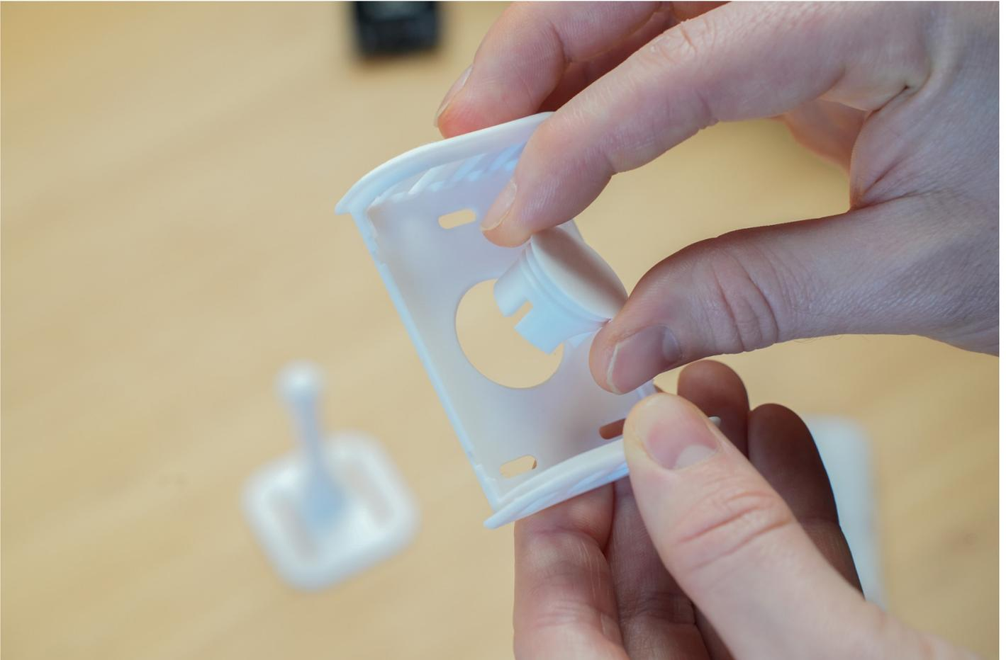
Stecken Sie das Kugelgelenk von vorne durch die Rückseite des Gehäuses. Halten Sie dann das Kugelgelenk fest und verwenden Sie den Sicherungsring, um es zu fixieren.
