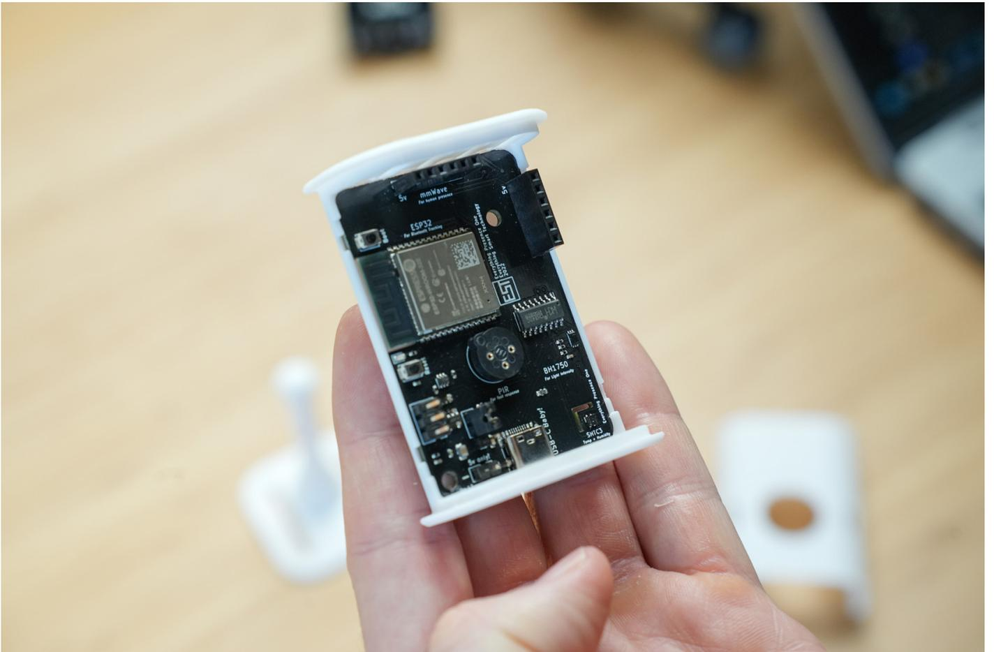
Nehmen Sie nun den mmWave-Sensor und setzen Sie ihn in einen der beiden Steckplätze ein.
